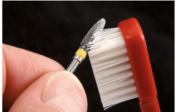
При легких загрязнениях чистить зубной щеткой. For cleaning slightly contaminated surfaces use a dental brush.
