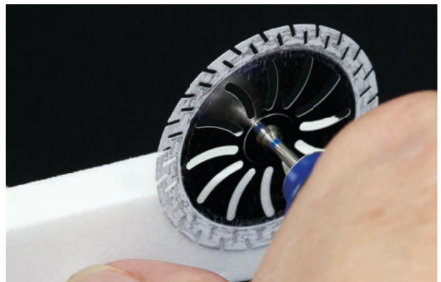
Очистка загрязненного алмазного покрытия. Cleaning the contaminated diamond coating.
